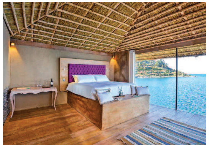
Amantica Lodge se crea a partir de una estructura de madera que se sostiene en pilotes anclados en el terreno. El piso se compone de totora, aserrín y cal, cerrándose con tablones de madera. El muro orientado al norte se compone de adobe. La terraza se protege del exterior a través de un vidrio templado y un techo de policarbonato. El techo de una estructura está forrado con un mix de totora, caucho reciclado y totora. El cerramiento final de totora se repite en los otros espacios como el baño, la cocina y el depósito.
